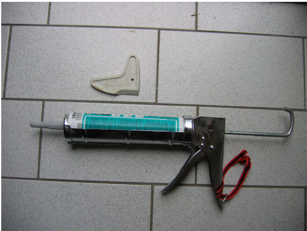
Abb.1: Werkzeuge zur Herstellung einer Siliconfuge
