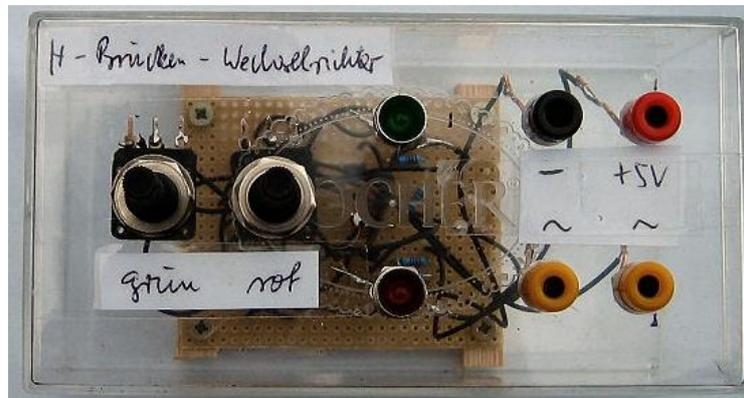
Abb. 3: H-Brückenwechselrichter
