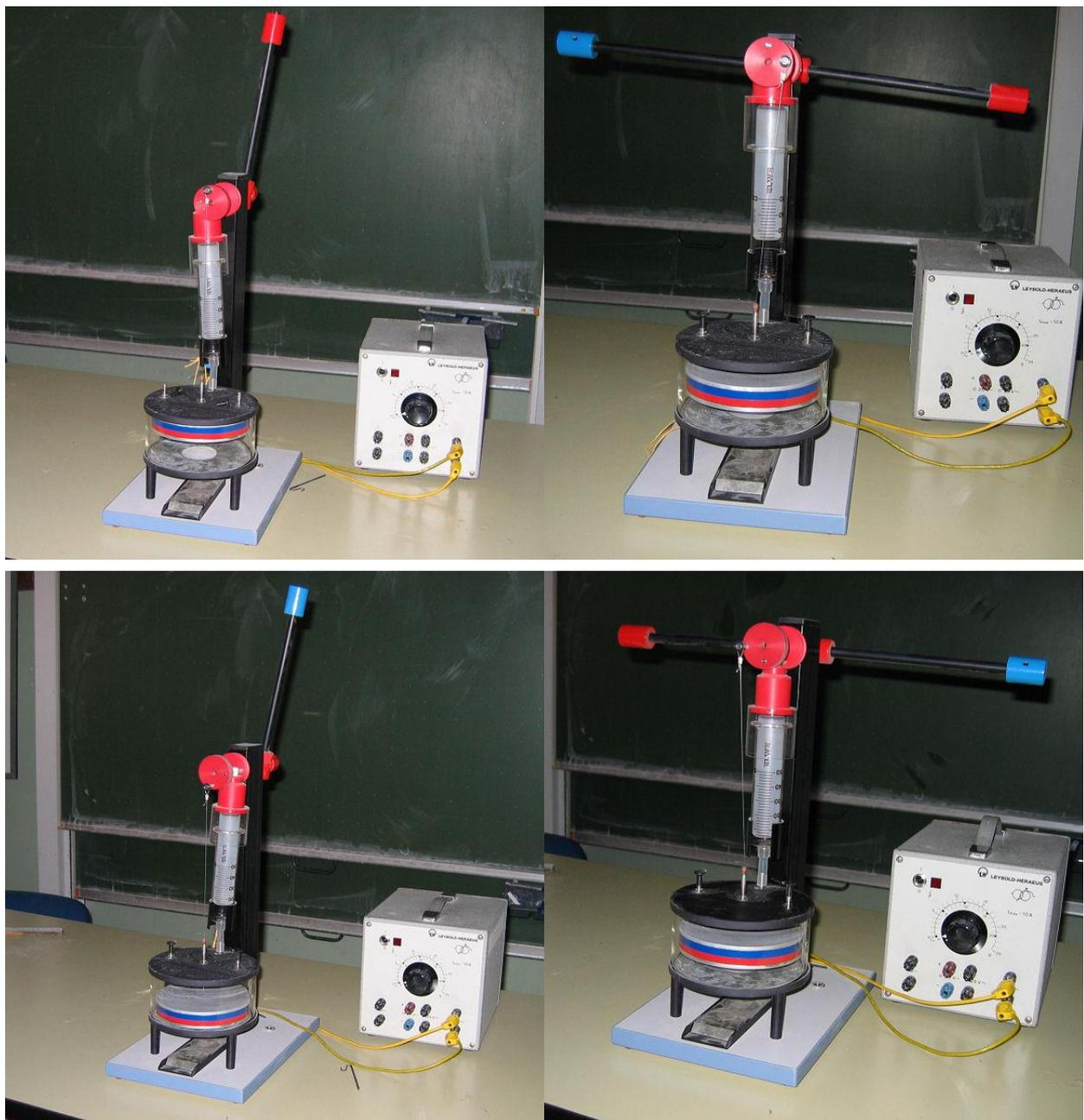
Abb.2: Takte eines Stirlingmotors
